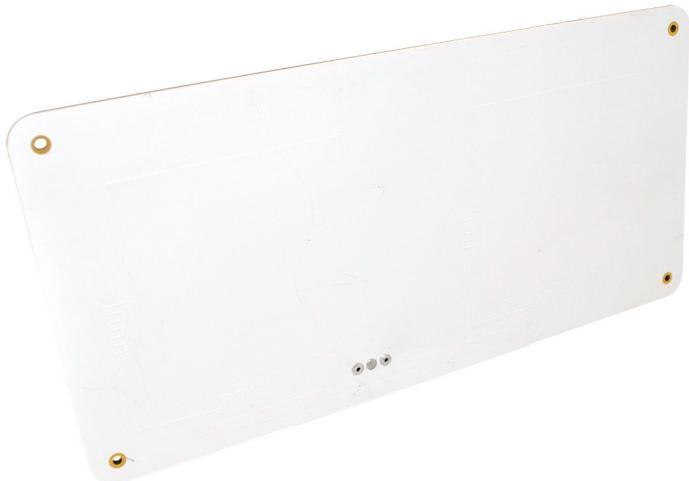
A antena UHF Advan p13 é uma antena patch RFID UHF de 3 elementos, compacta com polarização circular e um padrão de radiação caracterizado por uma largura de feixe de 40° na direção da antena de borda longa e 90° na direção da antena de borda curta.
