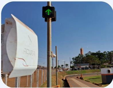
O HID Acura EDGE-30R+ AutoID é um leitor UHF RFID de alto desempenho projetado para aplicações de leitura de tags, visando principalmente o controle de acesso de veículos.
