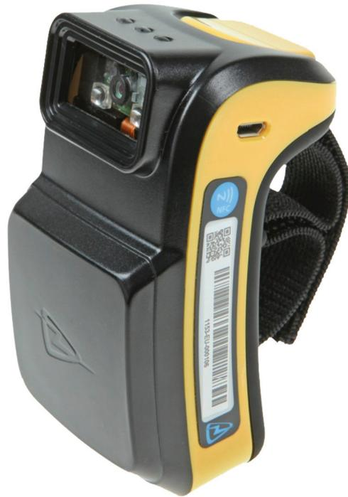
O TSL-1153 é um leitor projetado para leitura e gravação de tags UHF EPC Class 1 Gen 2 (ISO 18000-6C) e para comunicar-se com vários dispositivos via Bluetooth. O leitor é otimizado para baixo consumo de energia mantendo excelente performance e dimensões compactas. Também inclui scanner para leitura de códigos de barras 2D de alta performance, trazendo uma capacidade de coleta de dados incomparável.
